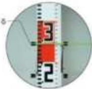
66ロッド・ミリ目付ロッドにワンタッチでピンボール・トラパーピンを固定
